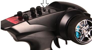
Mit dem Servowegumkehrschalter für den ersten Kanal (CH1) wird die Drehrichtung des Lenkservos umgekehrt.
